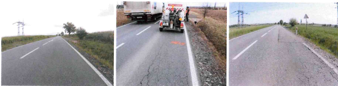
2019 (bez porušení), 2020 (síťové trhliny, deformace), 2022 (síťové trhliny – vývoj před a za výpravkou)
